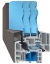
AFINO-art MD (Mitteldichtungssystem mit drei Dichtungen)
